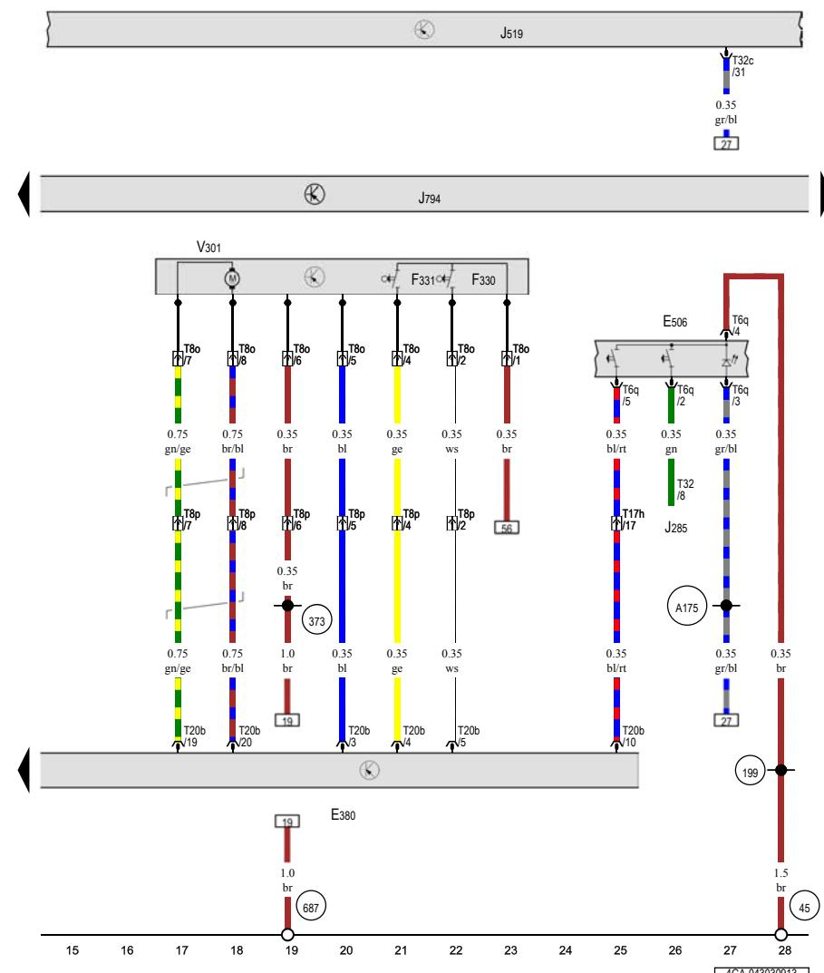
多媒体系统操作单元, 显示单元按钮, 显示器打开限位开关, 仪表板中的控制单元, 电子通讯信息设备 1 控制单元, 显示屏打开/关闭马达
